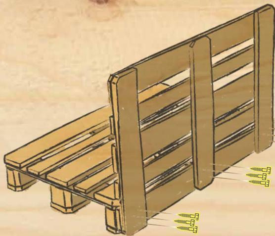
4. ANSCHLIESSEND DIE RÜCKWAND AN EINE GANZE PALETTE STELLEN UND FESTSCHRAUBEN. FÜR DIE ZWEITE BANK DEN ARBEITSSCHRITT WIEDERHOLEN.
