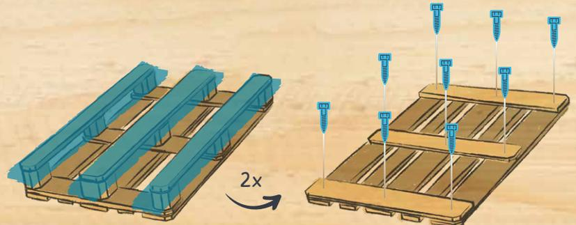
3A. FÜR DIE BEIDEN RÜCKWÄNDE BEI ZWEI PALETTEN DEN MARKIERTEN UNTERBAU ENTFERNEN.
