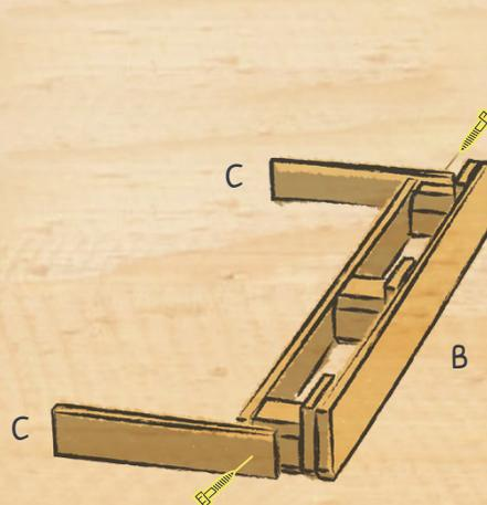
3. DIE C-TEILE MITTIG AN DEN KLOTZ VON TEIL B LEGEN UND MIT EINER SCHRAUBE LEICHT FESTSCHRAUBEN.
